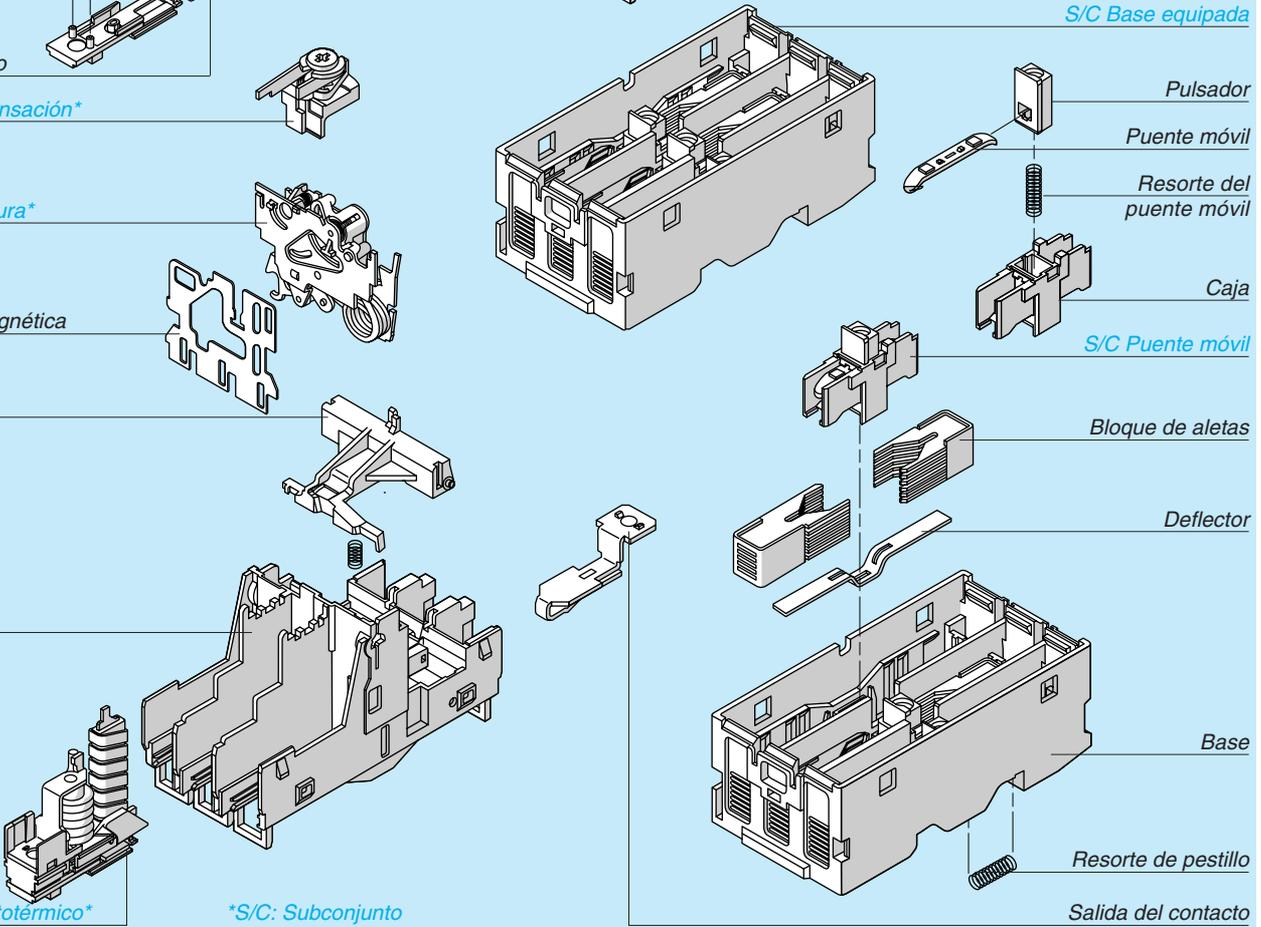
**Arrancador con disyuntor motor aislado**
