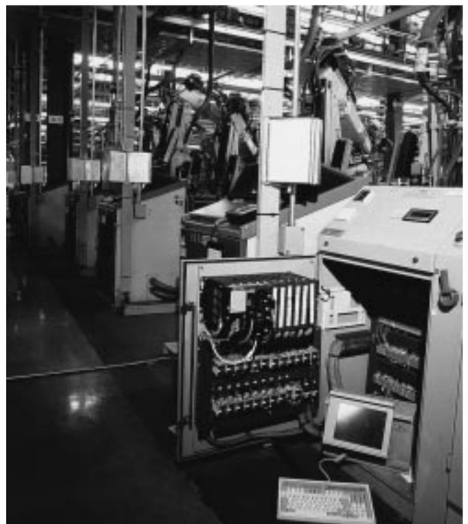
Autómata TSX de la serie 7 en una cadena de ensamblaje
