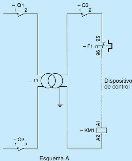
*Ninguna conexión del secundario ni del circuito de control al conductor de protección PE*
