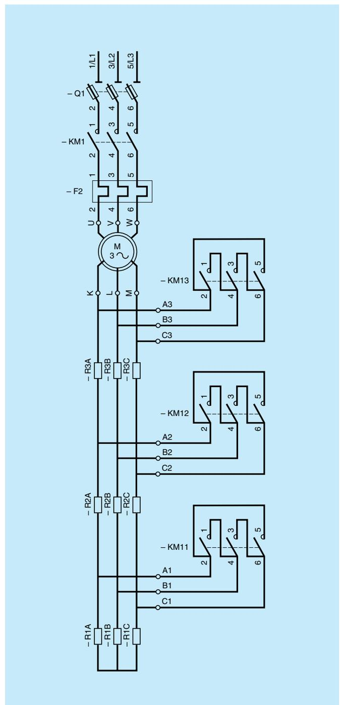
Arranque rotórico de 4 tiempos y contactores de cortocircuitado tripolares
