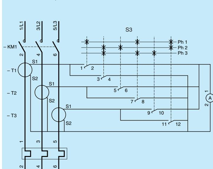
Voltímetro con conmutador de fases
