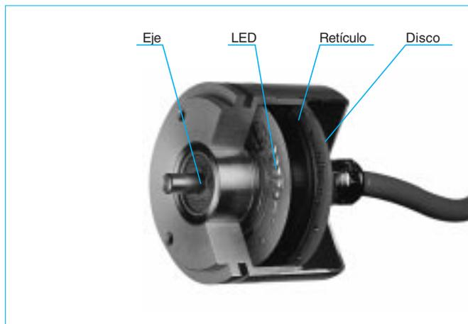
Composición de un codificador óptico rotativo incremental
