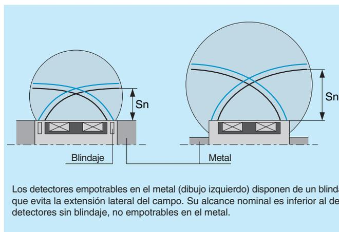
Los detectores empotrables en el metal (dibujo izquierdo) disponen de un blindaje que evita la extensión lateral del campo. Su alcance nominal es inferior al de los detectores sin blindaje, no empotrables en el metal.
