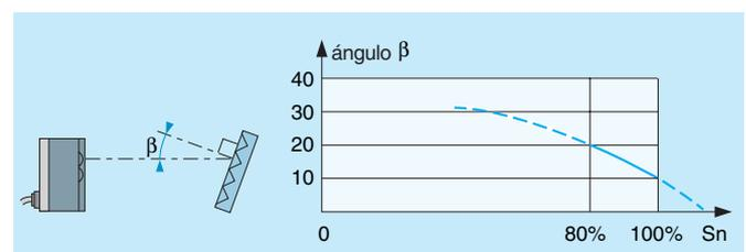
Alcance útil en función de la posición angular del reflector
