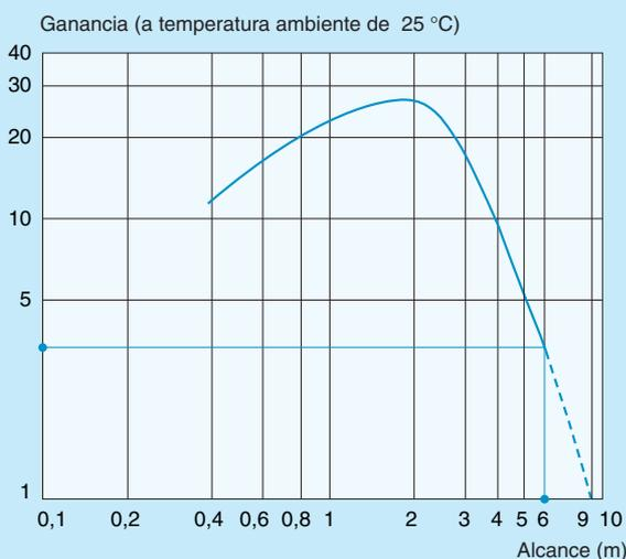
La curva de ganancia de un detector réflex no es lineal. La disminución de la ganancia en distancias cortas explica la existencia de una zona ciega. La reserva de ganancia más débil que la de un sistema de barrera requiere un estudio cuidadoso de las condiciones ambientales.
