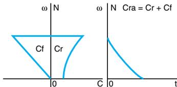
Si el tiempo de parada es inaceptable, debe aumentarse el par de ralentización de un par de frenado eléctrico  $C_f$  como:
