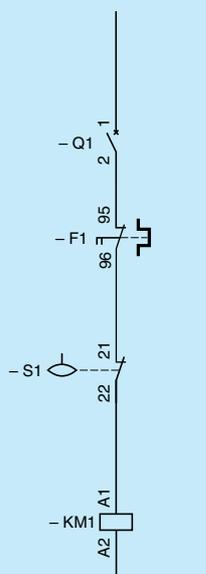
Control automático o manual, mediante conmutador "auto-parada-man"
