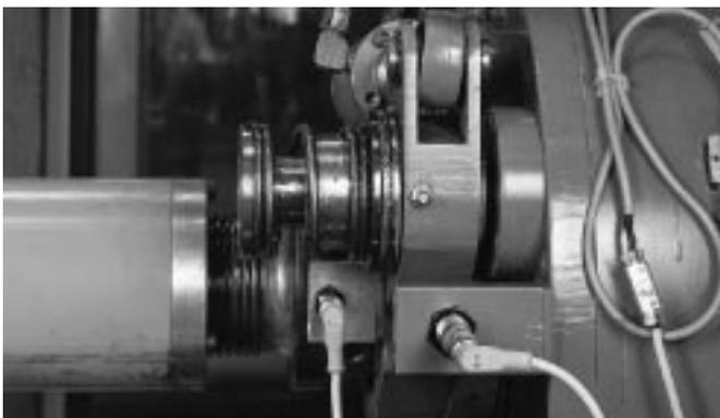
*Detectores XS de Telemecanique con conector*
