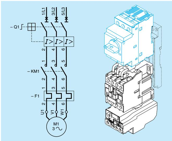
Disyuntor motor magnético + contactor + relé térmico
