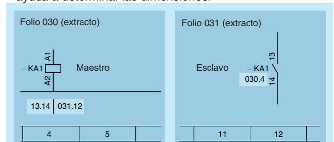
El contacto 13-14 de KA1 (esclavo) es controlado por la bobina del contactor KA1 (maestro). En el sector 4 del folio 030, el contactor KA1 se localiza fácilmente gracias a la información hallada al lado del contacto 13-14: 030.4. A su vez, en el sector 12 del folio 031, el contacto 13-14 se localiza gracias a la información 13.14: 031.12 situada debajo de la bobina KA1 (referencias cruzadas).
