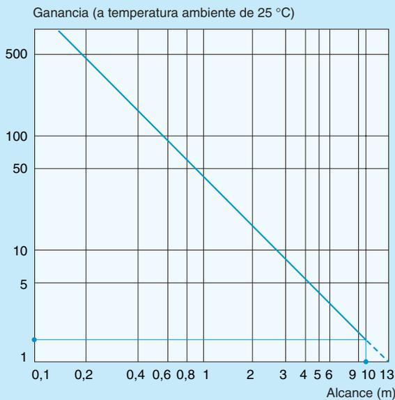
La curva de ganancia de un detector de barrera es lineal. La magnitud de la reserva de ganancia permite utilizar este tipo de detectores en entornos muy contaminados.
