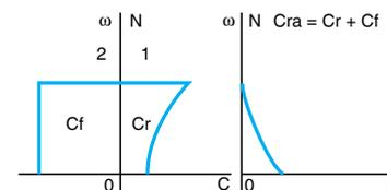
El frenado puede ser por recuperación; se obtiene utilizando variadores reversibles.
