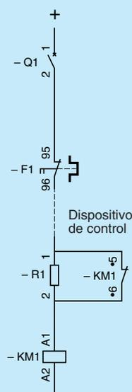
Corriente rectificada con rectificador incorporado al contactor
