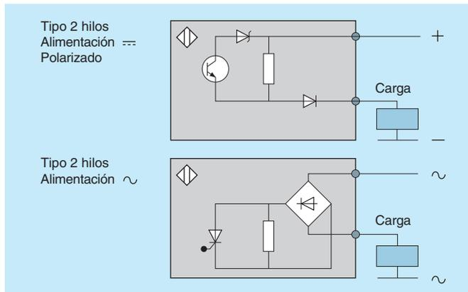
Detectores de 2 hilos: continuo polarizado y alterno
