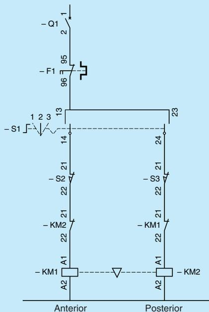
Mediante pulsadores a impulso e interruptores de posición
