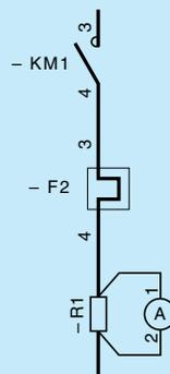
Amperímetro en transformador de corriente
